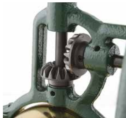
Coppia conica di ingranaggi sui modelli 140 per una agevole azione di macinatura
